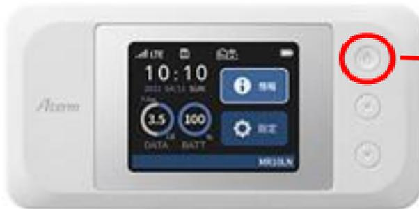
ディスプレイに「NEC」と表示されるまで電源ボタンを長押しし、電源をONにします
