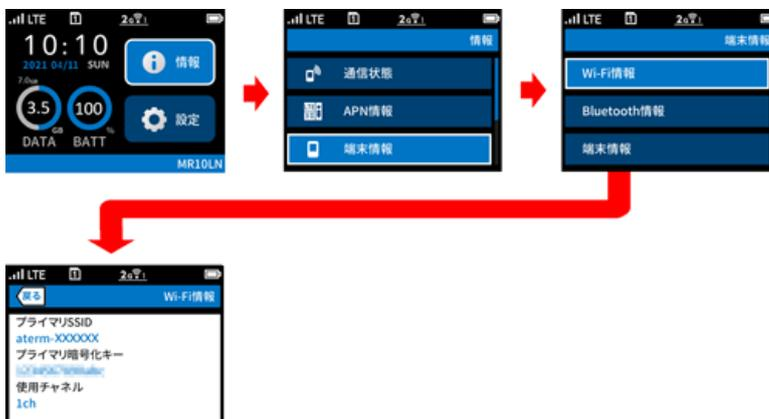
作業パソコンの「ワイヤレス ネットワーク」の設定を行い、控えたプライマリSSIDと暗号化キー(AES)でWiFi接続します。
