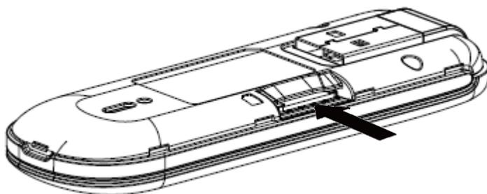
②SIM カードが出てきたら IC 部に注意し、矢印の方向にスライドさせ SIM カードを取り外してください。
